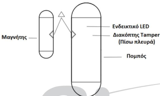
Η ασύρματη μαγνητική επαφή WMC-200 συνεργάζεται με την ασύρματη επέκταση WPX-48. Διαθέτει CPU χαμηλής κατανάλωσης. Έχει μεγάλη εμβέλεια, της τάξης των 100 μέτρων σε ανοικτό πεδίο, με οπτική επαφή.
