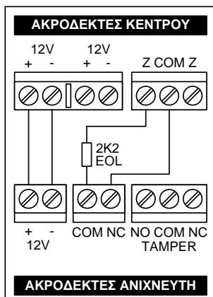
Αν η εγκατάσταση σας δεν απαιτεί την χρήση Tamper, συνδέστε τους ανιχνευτές όπως φαίνεται στο σχήμα. Η αντίσταση θα πρέπει να τοποθετηθεί μέσα στον ανιχνευτή και όχι στον πίνακα. Η σύνδεση αυτή θα προστατεύει μόνο το καλώδιο του ανιχνευτή από κόψιμο ή βραχυκύκλωμα, και μόνον όταν το σύστημα είναι οπλισμένο.
