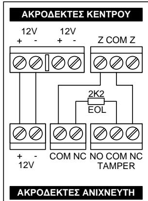
Στην περίπτωση που θέλετε να χρησιμοποιήσετε μία τερματική αντίσταση και να συνδέσετε στην ίδια ζώνη τον Tamper και το Relay συναγερμού του ανιχνευτή, χρησιμοποιήστε την συνδεσμολογία που εικονίζεται στο διπλανό σχήμα. Στην συνδεσμολογία αυτή ο Tamper θα δίνει συναγερμό μόνον όταν ο πίνακας είναι οπλισμένος, αλλά δεν θα έχουμε 24ωρη προστασία του ανιχνευτή από παραβίαση.
