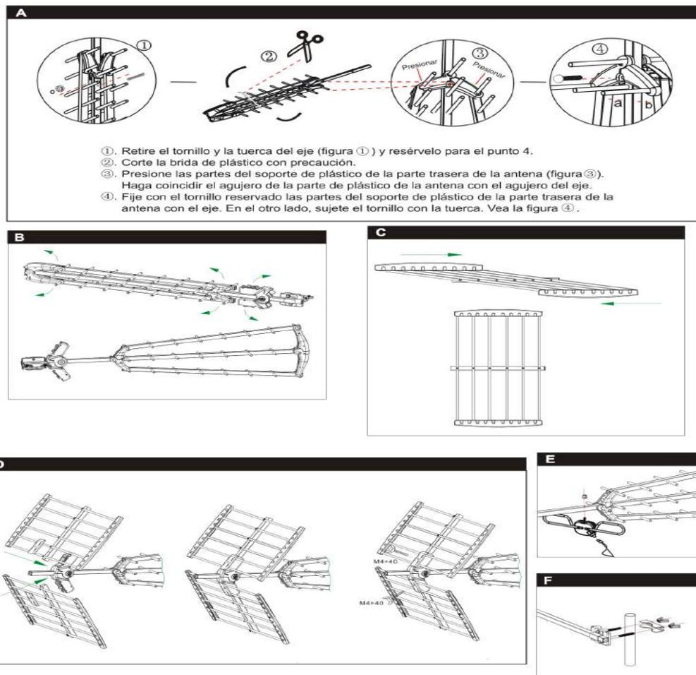
\*Esta antena Tecatel está garantizada para soportar rachas de viento de 180 km/h sin que se suelte ninguna pieza. No obstante, en la instalación se deben tomar las medidas de seguridad adecuadas a cada soporte de fijación. Además, la instalación debe realizarse en un lugar protegido del viento, para evitar vibraciones y fatigas continuas que podrían producir desajustes indeseados.
